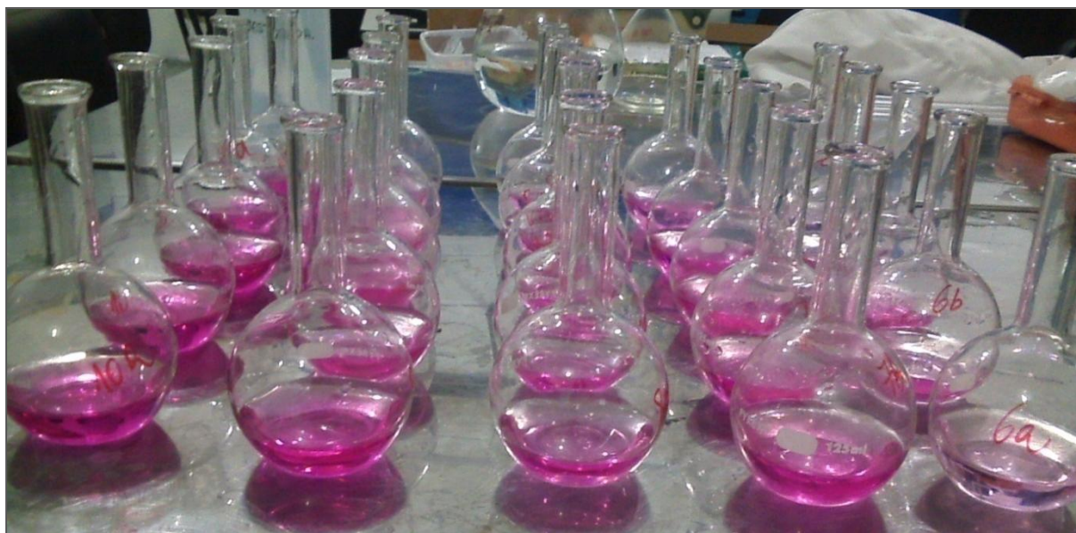
Figura 2 - Solução obtida após a adição solução de sulfanilamida com bicloridrato de naftil-1-etilenodiamina em meio ácido em amostras de água mineral durante o tempo reacional de 15 minutos.
