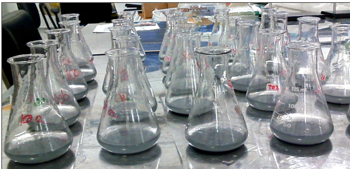
Figura 1 - Processo de redução do íon nitrato ao íon nitrito que estão presentes nas amostras de água mineral e também nas soluções padrão de nitrato utilizando o zinco em pó como agente redutor.
